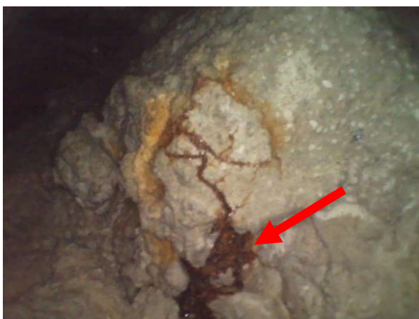
Obr. 7.5: Detailní endoskopické snímky výskytu koroze a korozních produktů v místě sekané sondy styčníku SLOUP-VAZNÍK VB-2
